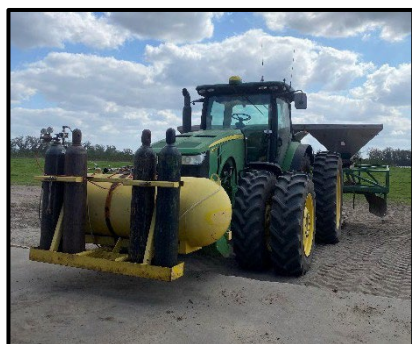
Sistema cerrado para aplicación de TELONE™ by Teleos con un tanque contenedor y cilindros para mantener el fumigante y sistema de presión de nitrógeno.
